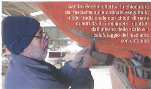
Sandro Pezzini effettua la chiodatura del fasciame sulle ordinate eseguita in modo tradizionale con chiodi di rame quadrati da 3,5 millimetri, ribattuti dall'interno dello scafo e il calafataggio del fasciame con cotonina
