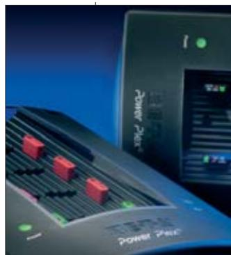
Il Sistema PowerPlex è il nuovo sistema di protezione e controllo degli impianti elettrici della E-t-a. Riduce l'esigenza di cablaggi convenzionali, è costituito da più moduli posizionabili a piacimento, collegati ai carichi, agli interruttori e ai sensori. I vari componenti comunicano fra loro via Can bus, funzionando come un unico sistema, attraverso delle interfacce di controllo e un
